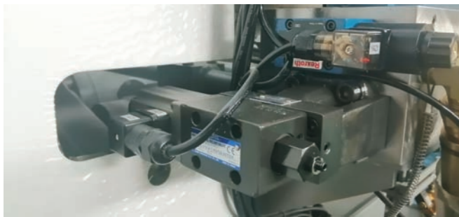
数控背压 电脑直接设定背压值， 方便调整塑化工艺
