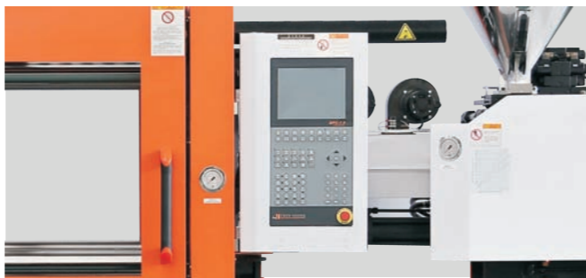
10.4寸大屏专用电脑控制系统 标配MPC7.0智能联网电脑控制器
